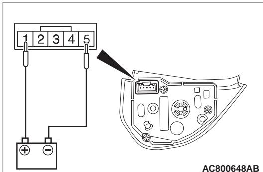
向方向盘音响遥控开关插接器的 1 号、5 号端子施加蓄电池电压，然后检查方向盘音响遥控开关是否点亮。
